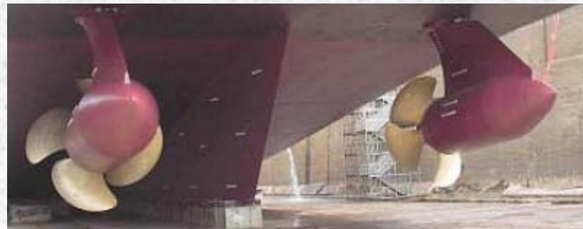
Deux Pods Mermaid de 7MW propulsent le navire
