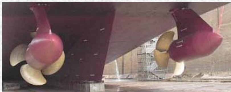
Deux Pods Mermaid de 7MW propulsent le navire
